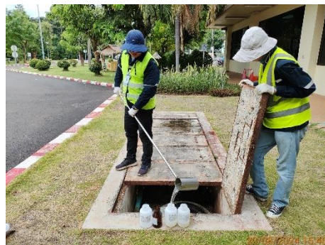
บ่อกักน้ำทิ้งหลังผ่านระบบบำบัดน้ำเสีย ของอาคารที่พักผู้โดยสาร ชุดที่ 1
