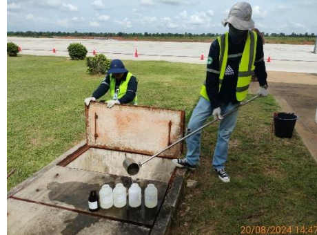
บ่อบำบัดน้ำทิ้งหลังผ่านระบบบำบัดน้ำเสีย ของอาคารที่พักผู้โดยสาร ชุดที่ 2
